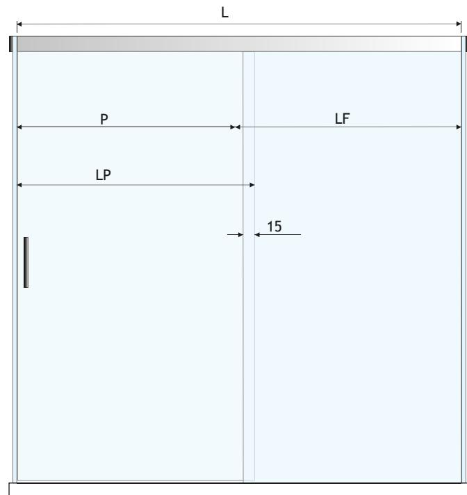
La rotaia è fornita con lunghezza 1500 mm o 2200 mm a seconda del kit. Tagliarne un'estremità in funzione della misura necessaria.
