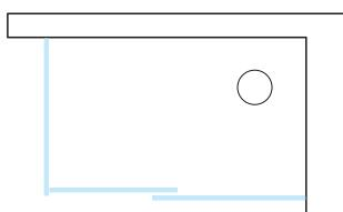
La rotaia è fornita con lunghezza 1500 mm o 2200 mm a seconda del kit. Tagliarne un'estremità in funzione della misura necessaria.
